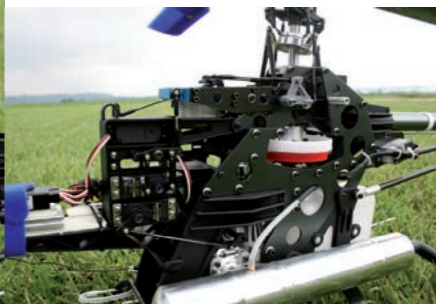
Dämpferschlauch und Heckservoleitung wurden mit einem Schrumpfschlauch gegen Durchscheuern gesichert. Der O.S.-Motor wird mit einem Hatori-938-Dämpfer betrieben
