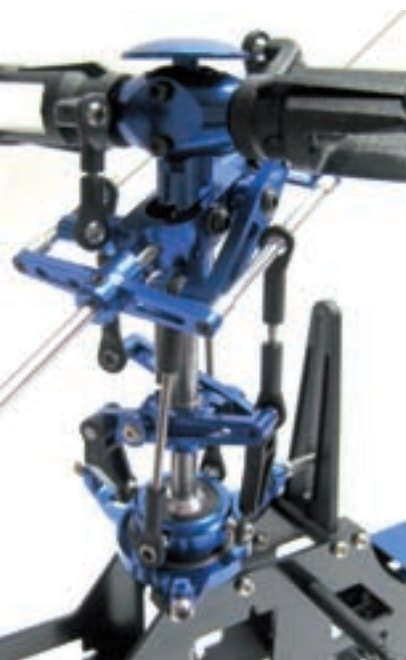
Der Rotorkopf besteht mit Ausnahme der Blatthalter komplett aus blau eloxiertem Alu
