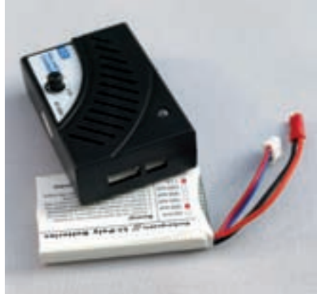
Das Ladegerät ist für zwei- und dreizellige Akkus geeignet und hat einen integrierten Balancer
