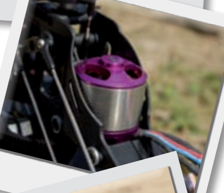
Als Antrieb für einen Helikopter ist ein Außenläufer-Brushlessmotor die richtige Wahl
