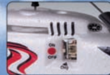
Auf der rechten Rumpfhälfte befinden sich gut zugänglich die Ladebuchse und der Hauptschalter für das Modell.
