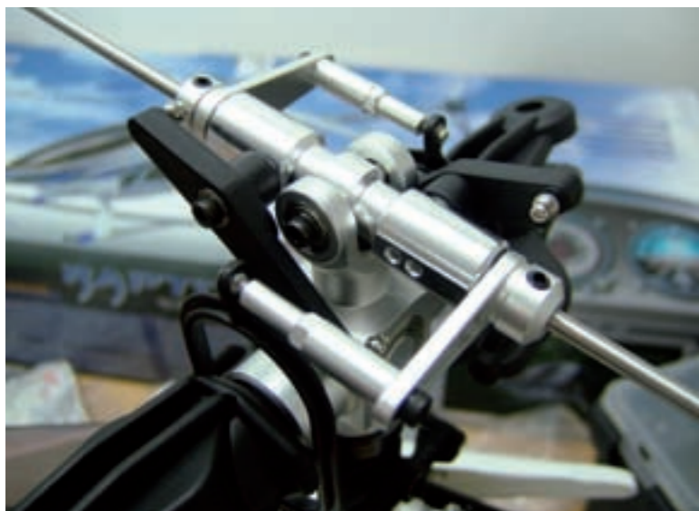
Die Originale Pitch-Wippe wurde gegen blau anodisierte aus Alu und CFK ausgetauscht. Das sorgt für eine noch schnellere Kraftübertragung vom Pitchservo zum Rotorkopf
