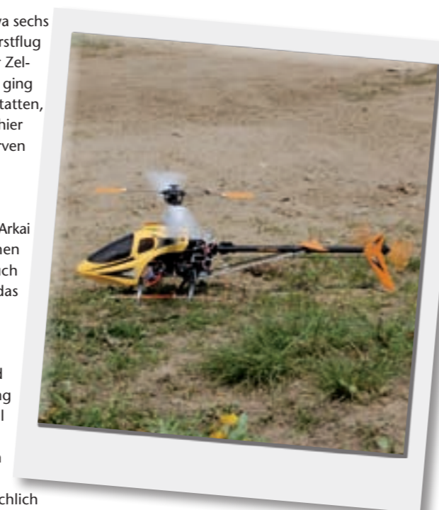
Obwohl aus Holz gefertigt, zeigten die Hauptrotorblätter einen exakten Spurlauf
