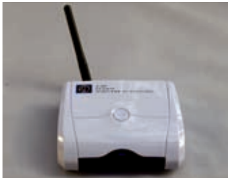
Das Videosystem arbeitet im 2,4 GHz Band, der Empfänger wird über den USB-Port versorgt
