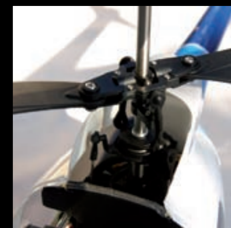
Der angelenkte untere Rotorkopf und die Taumelscheibe sind praxistauglich gestaltet
