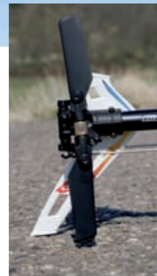
Das Heck mit seiner absolut spielfreien Push-Pull-Anlenkung und der im Text erwähnten sehr knappen Bodenfreiheit der Heckrotorblätter
