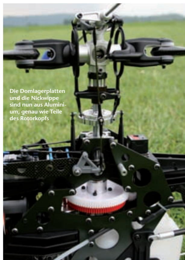
Die Originale Pitch-Wippe wurde gegen blau anodisierte aus Alu und CFK ausgetauscht. Das sorgt für eine noch schnellere Kraftübertragung vom Pitchservo zum Rotorkopf
