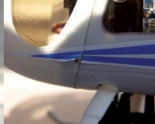
Die Haube ist mit vier kleinen Schrauben montiert, zwei davon sind allerdings unter dem Zierstreifen versteckt
