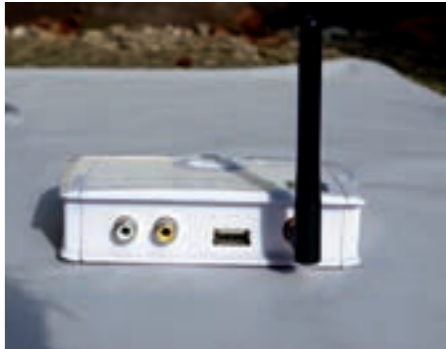
Der Empfänger kann entweder am PC über USB oder einer Videokamera oder Fernseher betrieben werden
