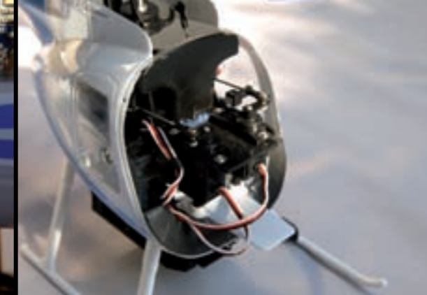
Die verbauten Komponenten machen einen guten Eindruck, praktischerweise sind Empfänger und Steuerelektronik getrennte Einheiten
