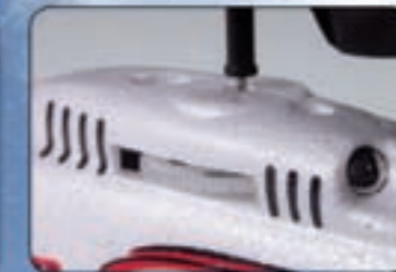
Das Hauptrotorrad ragt auf beiden Seiten aus dem Rumpf heraus. So lässt sich der Zustand der Zähne nach jedem Flug einfach kontrollieren.
