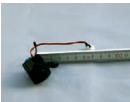
Aktuelle Technik, dieser kleine Würfel beinhaltet eine VGA Farbvideokamera mit Ton und Funkübertragung
