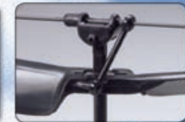
Das spezielle One-Link-Rotorkopfsystem ist genial einfach aufgebaut. Paddelstange und Rotorblätter sind mit einer Anlenkung verbunden.
