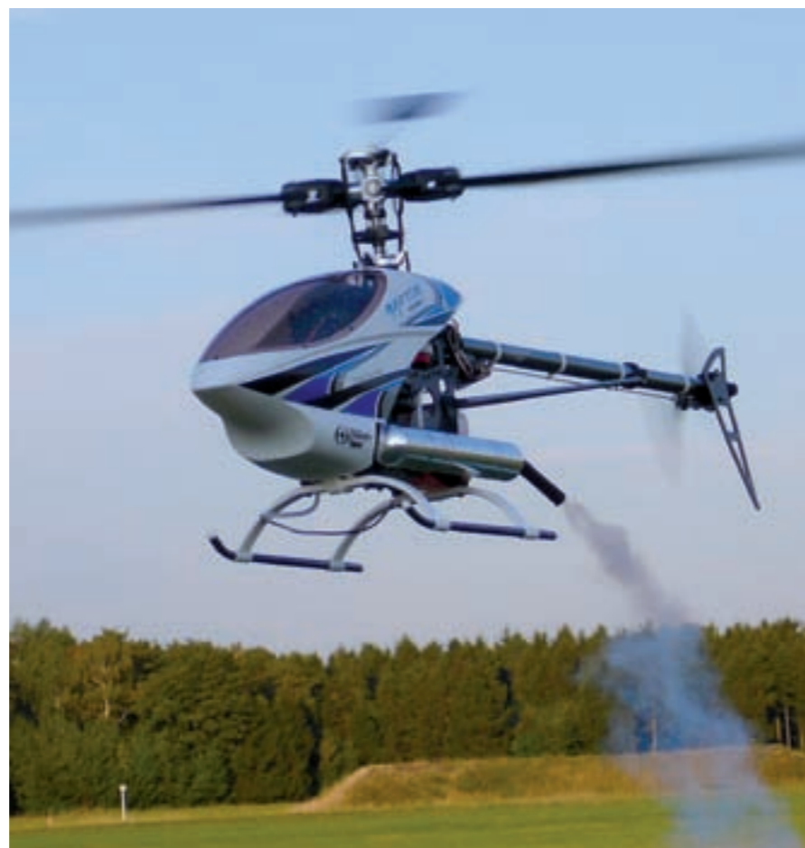
Der Raptor 90 3D in seinem Element, hier mit noch recht fett eingestelltem Motor. Die zahlreichen Tungeteile machen einfach Spaß und sehen dazu noch gut aus. Durch CFK/GFK-Kanzel, CFK-Kufenbügel und Heckstreben ist der Heli zudem nochmal 156 Gramm leichter
