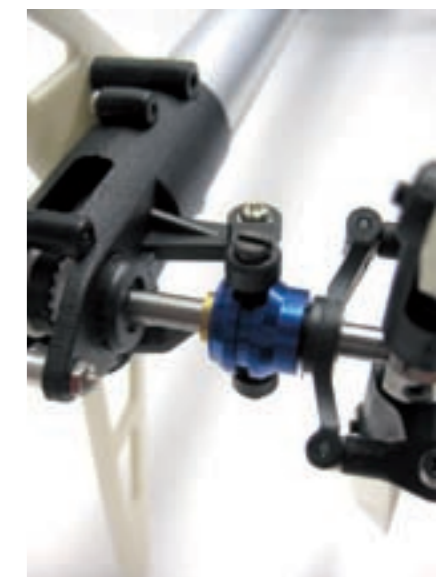
Die Scherenanlenkung im Heck sorgt für präzises Steuern
