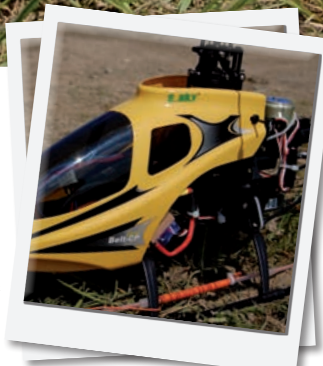
Die Lexanhaube passt sich exakt an das schmale Chassis an
